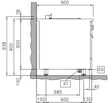
Electrical inlet (power) Equipotential screw
